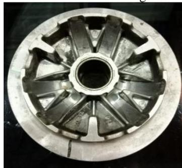
Gambar 9. Jalur roller primary shift CVT kerok
