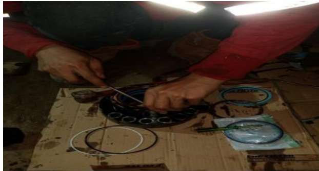
Gambar 4. Penggantian Seal Kit Silinder hidrolik excavator
