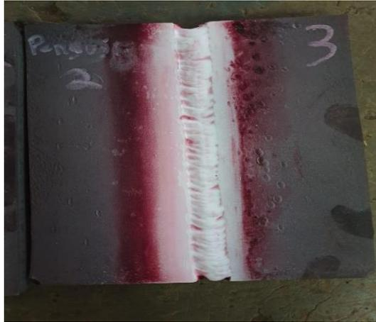
Picture 11. hasil pengujian penetran test pada penampang AB2 pola melingkar
