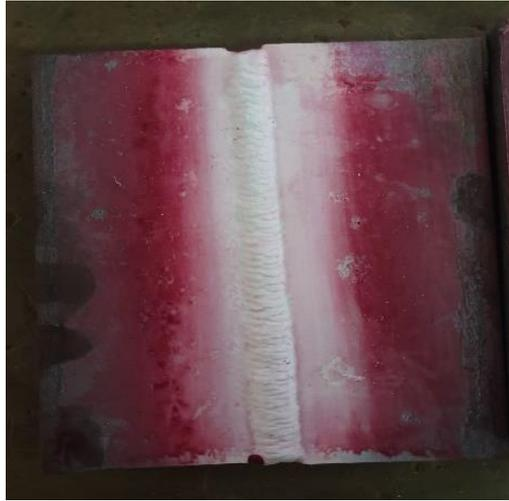
Picture 1. hasil pengujian *penetrant test* pada penampang AB1 pola zig zag
