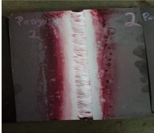
Picture 7. hasil pengujian *penetran test* pada penampang AB2 pola u
