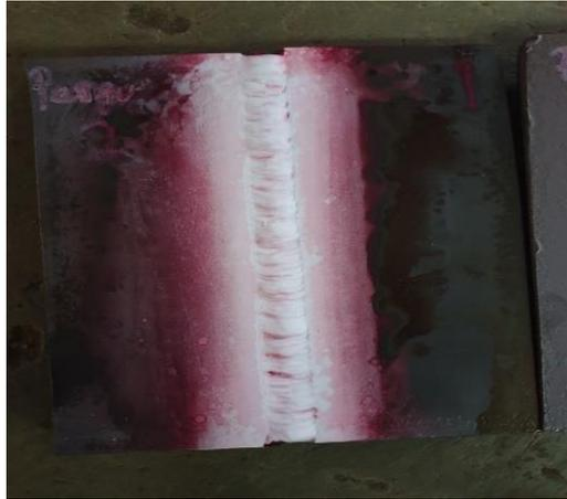
Picture 3. hasil pengujian *penetran test* pada penampang AB2 pola zig zag
