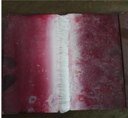
**Picture 5.** hasil pengujian *penetran test* pada penampang AB1 pola u
