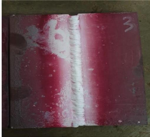
Picture 9. hasil pengujian *penetran test* pada penampang AB1 pola melingkar
