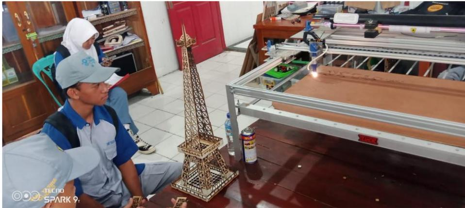
Gambar Proses Cutting Acrilic dengan Mini CNC Laser
