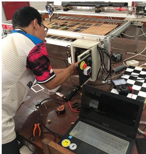
Gambar Proses Setting Rangkaian Control mini CNC dan Pemrograman
