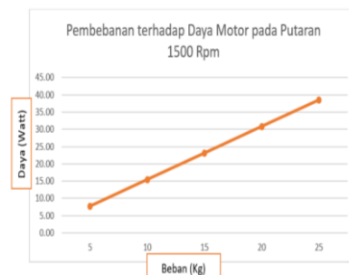
Gambar 5. Pengaruh Besarnya Beban Terhadap Daya Motor Putaran 1500 Rpm
