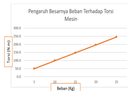
Gambar 3. Pengaruh Besarnya Beban terhadap Torsi Mesin
