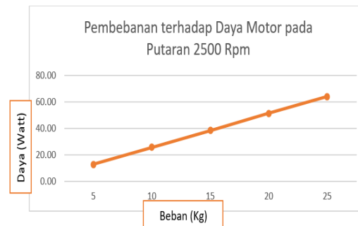
Gambar 7. Pengaruh Besarnya Beban Terhadap Daya Motor Putaran 2500 Rpm
