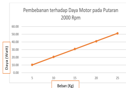
Gambar 6. Pengaruh Besarnya Beban Terhadap Daya Motor Putaran 2000 Rpm
