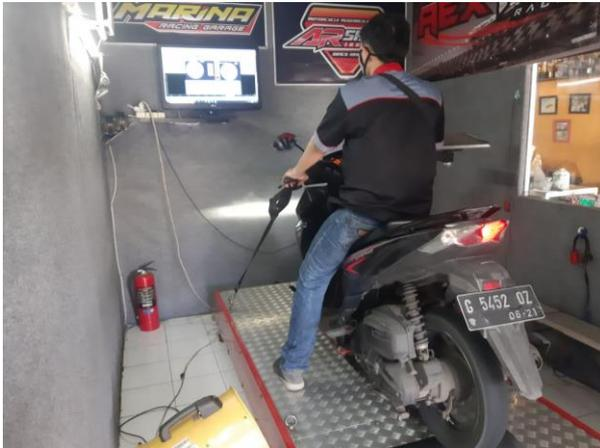
**Gambar 4.** Proses Pengambilan Data Performa Mesin Daya dan Torsi
