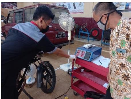
**Gambar 4.** Proses Pengambilan data menggunakan Gas Analyzer
