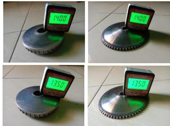
Gambar 1. Sudut Kontak *Drive Pulley*  $14^\circ$  dan  $13,5^\circ$
