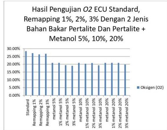
Gambar 21. Hasil pengujian O2 ECU standard, remapping 1%, 2%, 3% dengan metanol 5%, 10%, 20%
