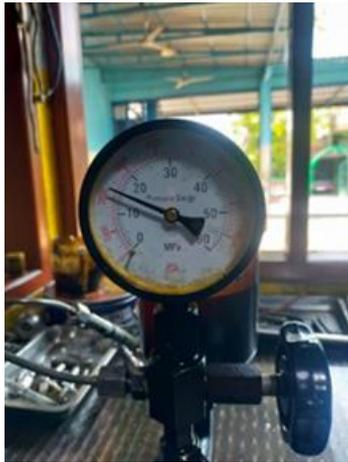
**Gambar 5.** Tekanan Injector Nozzel dengan Ketebalan Shim 0,7 mm
