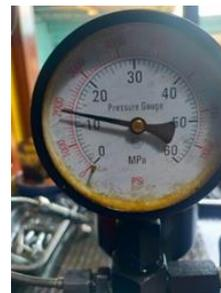
**Gambar 3.** Uji Tekanan Injector Nozzel dengan Ketebalan Shim 0,5 mm
