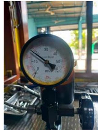
**Gambar 7.** Uji Tekanan Injector Nozzel dengan Ketebalan Shim 1,1 mm
