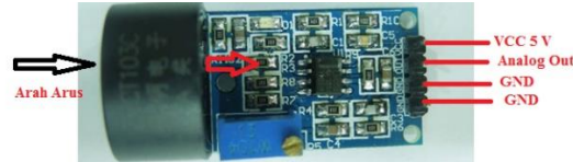
Gambar 4. Konfigurasi pin untuk pemasangan sensor arus ZMCT103C.
