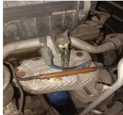
Gambar 3. Pemasangan Pipa Katalis HCS penghemat Bahan Bakar Pada:
