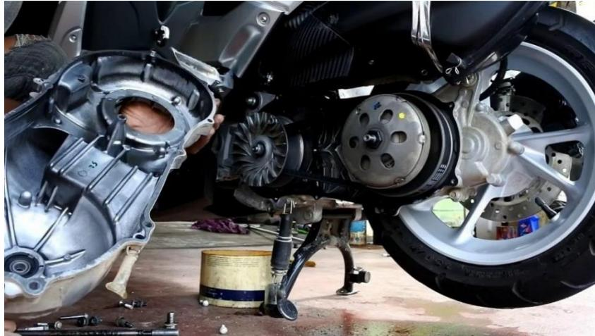
Gambar 4. Vanbelt sepeda motor matic jenis NMax.
