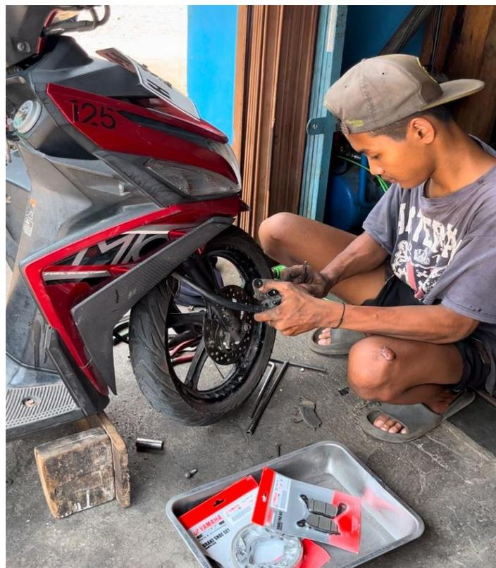
Gambar 3. Proses Pemasangan Kampas Rem
