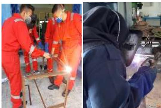
Gambar 1. Kondisi Praktikan (kiri) yang tidak lengkap menggunakan alat pelindung diri dan (kanan) praktikan yang menggunakan alat pelindung diri dengan benar.
