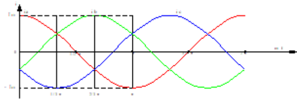
Gambar 1. Keadaan Arus Tiga Phase Yang Dimasukkan Pada Lilitan Stator Pada Suatu Saat Tertentu.
