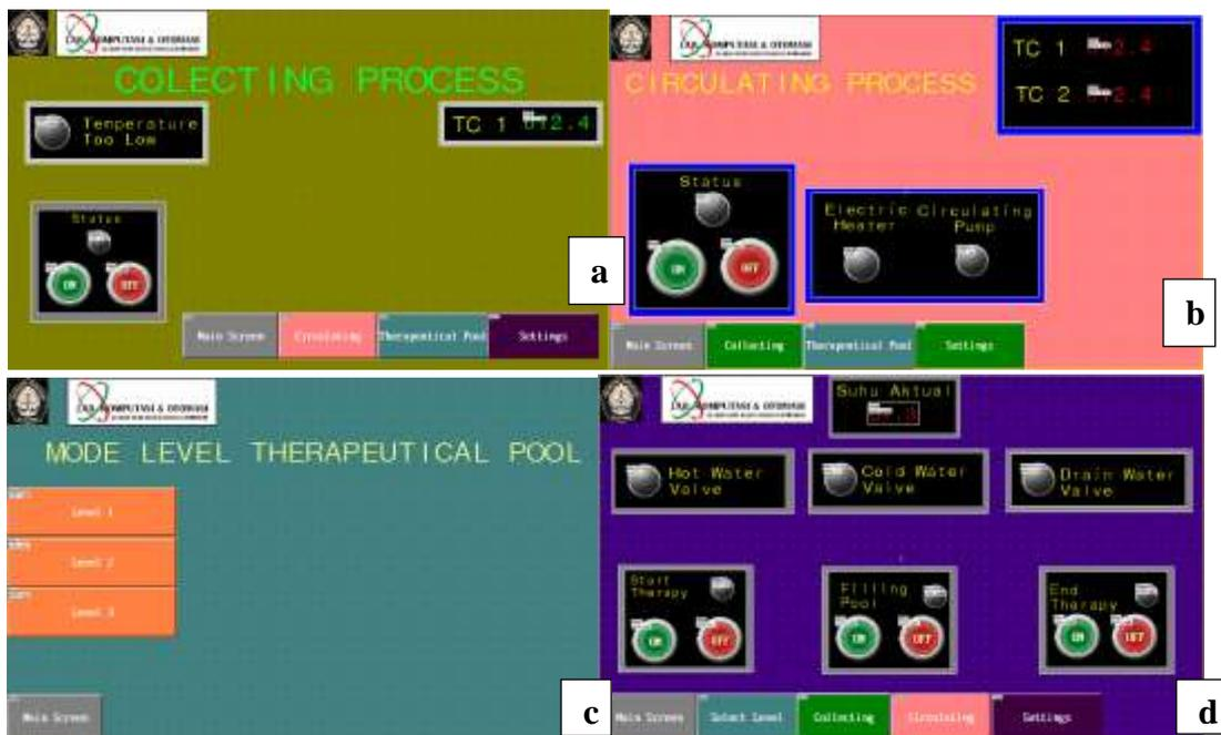
**Gambar 10.** *Display panel* pada HMI untuk, a) Proses *Collecting*, b) Proses *Circulating*, c) Mode level air, d) Proses *mixing*
