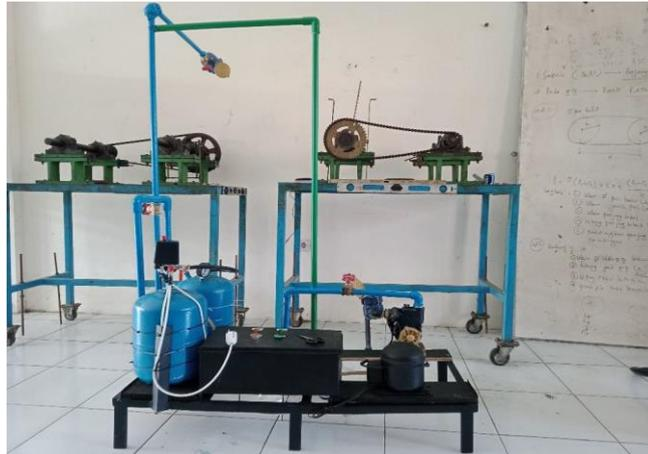
Gambar 1 Alat Peraga Hydrophore Tank 3 belokan 1 katup pipa 0,75 inci
