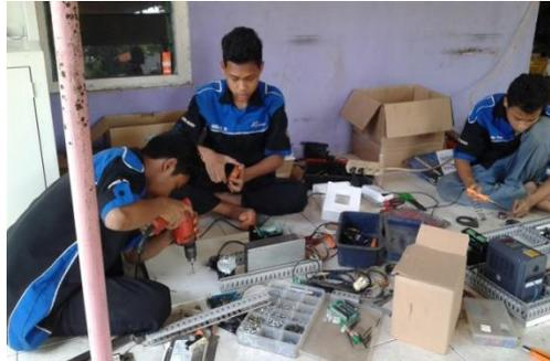
**Gambar 2.** Installasi frame mesin ukir kaligrafi kayu
